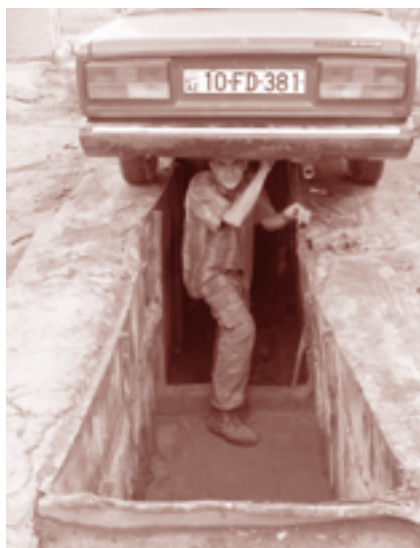
Hvordan komme til under en bil? Man graver simpelthen en grøft i bakken.
