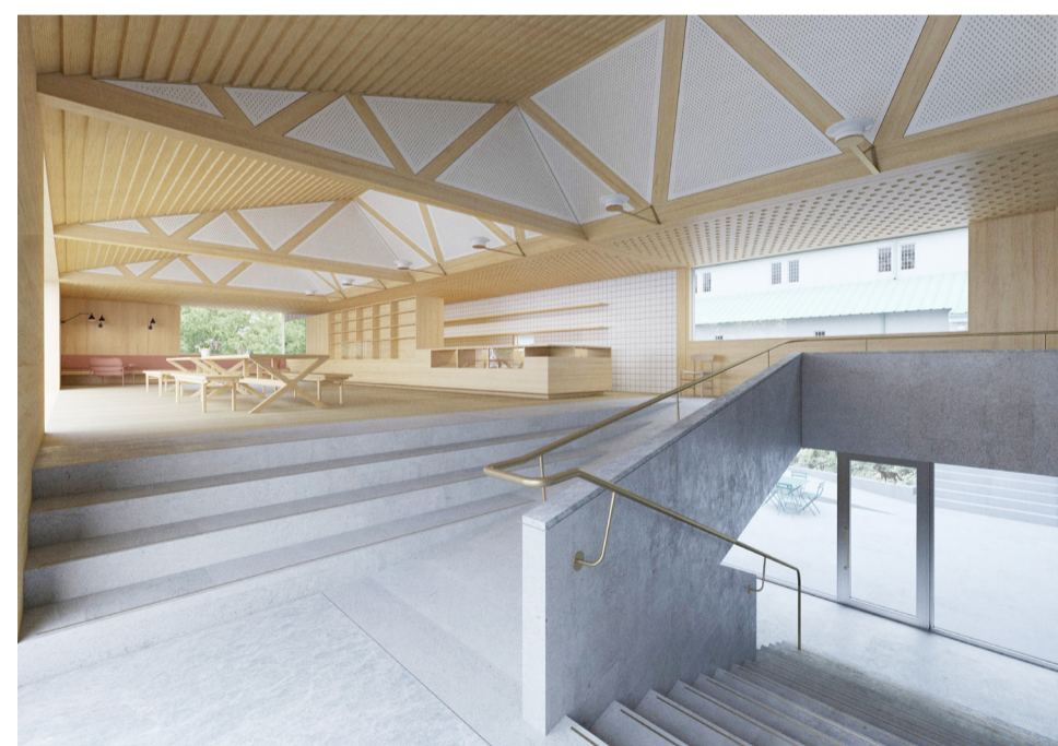
Kaféinteriør for fargesetting. De perforerte fyllingene i takkonstruksjonens fagverk skjuler akustiske lydabsorbenter som vil gi rommet en behagelig akustikk. Fargesettingen kan utføres som kunstnerisk utsmykking, eller som en arkitektonisk frise basert på kirkens eksisterende fargepalett.
