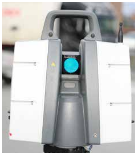
Slik ser den tredimensjonale laserscanneren ut.
